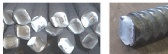
写真 7.2.2 平刃シャー切断機による切断面の例 7.4)
